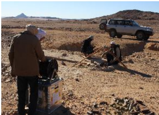
Fig.3 : Mesure de température dans un forage au Hoggar. © Bouzid
