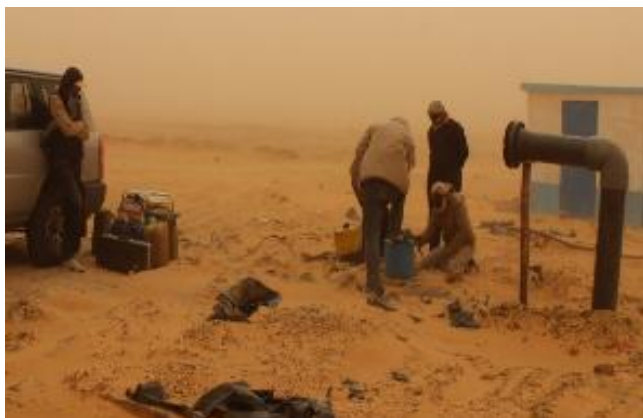
Fig.4 : Mesure de température dans un forage à In Guezzam à l'extrême sud algérien. © Bouzid
