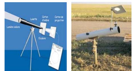
Télescope et lunette astronomique avec projection de l'éclipse sur un écran
