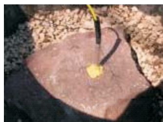
Fig. 2 : Dispositif expérimental utilisant l'explosif (détonateur fixé à la
