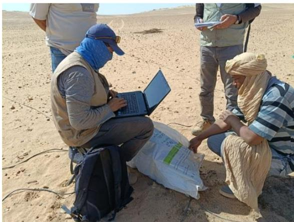
Paramétrisation du système de mesure MT avant le lancement des enregistrements pour une durée de 18 à 20 h. sur la photo, Boukhalfa et Baybour. © CRAAG
