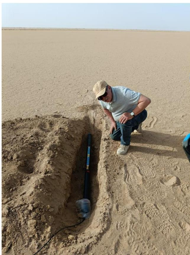
Installation de la bobine d'induction pour la mesure d'une des composantes horizontales du champ magnétique. Sur la photo, Pr M. Hamoudi. © CRAAG
