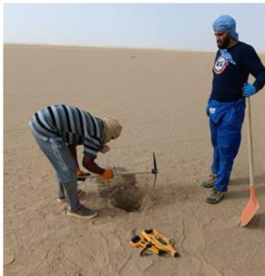
Préparation d'un trou pour installer une électrode.
