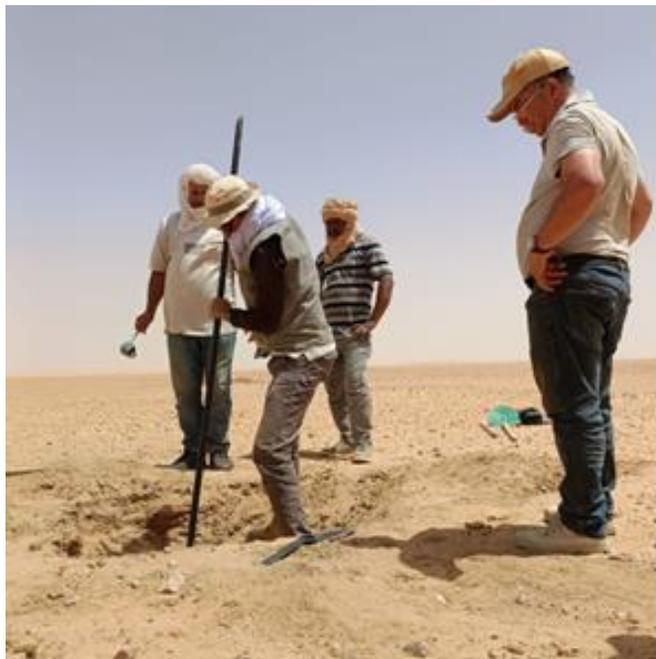
Creusement du trou pour accueillir la bobine d'induction verticale (Hz). Sur la photo, de g. à d. Bendekken, Bouzid, Baybour et Hamoudi. © CRAAG
